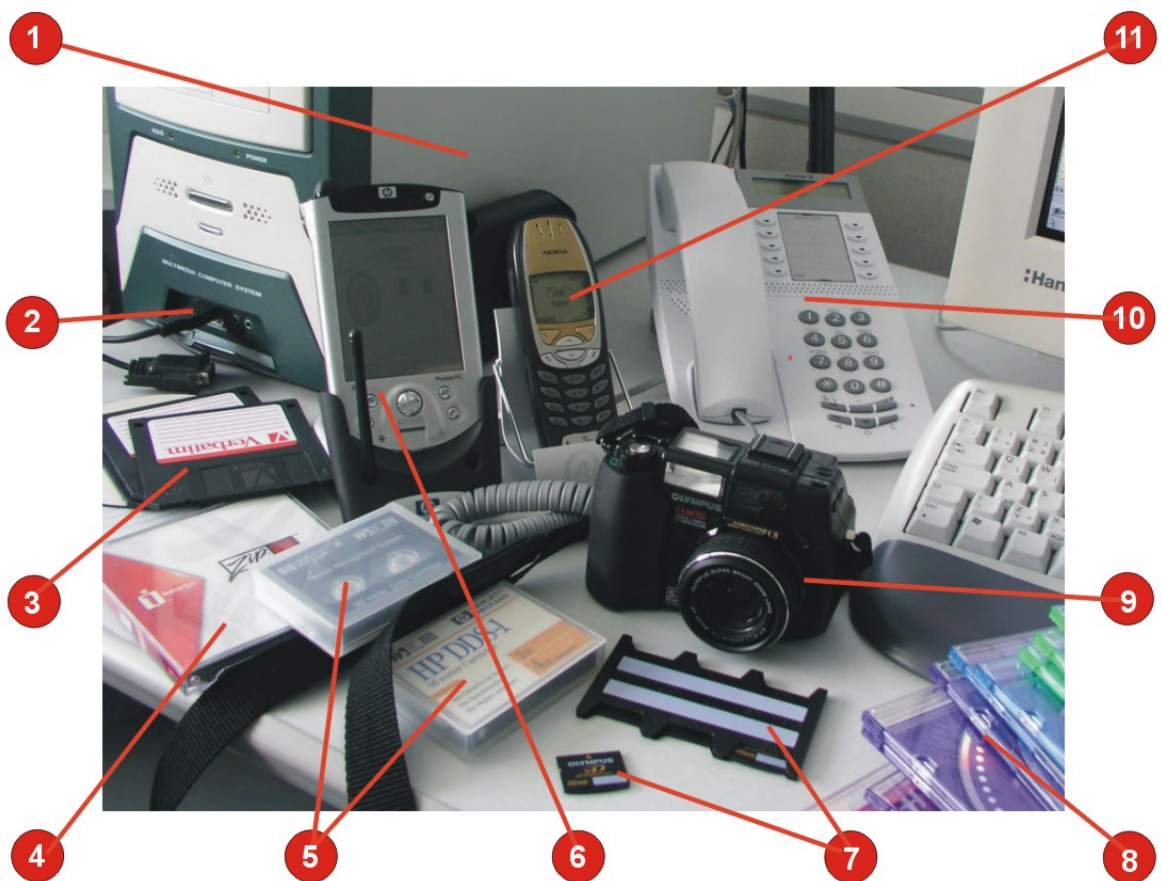
Obr. 1: Příklady zdrojů digitálních dat (stop). Např.: 1 – disky PC, serverů, datová uložistiště, datové sklady, archívy apod. 2 – externí, přenositelné disky, USB 4 . 3 - diskety. 4 - speciální archivní optická média. 5 – datové pásky. 6 – osobní organizéry (PDA 5 , MDA 6 ). 7 – rozmanitá paměťová média, „mikrodisky“, 8 – CD, DVD, Blue Ray disky. 9 – rozmanitá digitální zařízení – fotoaparáty, videokamery, palubní počítačové jednotky vozidel, letadel, lodí, tzv. „černé schránky“ atd., 10 – paměti stolních telefonů, telefonní ústředny, 11 – mobilní telefony, GPS navigace atd.
